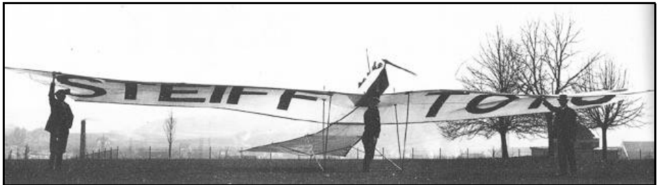
Werbe-Drachen in Flugzeugform der Firma Steiff. Die Form erinnert tatsächlich an die „Antoinette“
